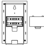
Die Temperaturstation arbeitet mit zwei 1,5 V-Batterien vom Typ Mignon AA, IEC LR6. Folgen Sie beim Einlegen und Ersetzen der Batterien bitte folgenden Schritten:
