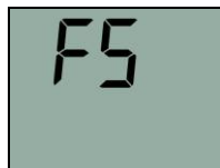
Displayanzeige nach Tastendruck. FS = Factory settings (Werkseinstellungen)
