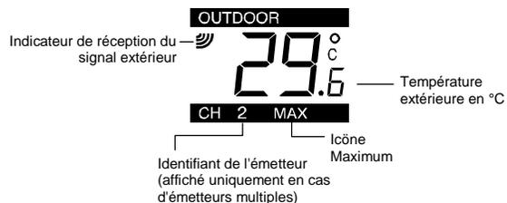
La dernière section de l'écran LCD affiche la température extérieure et une icône de réception du signal ; l'identifiant de l'émetteur est affiché sous la température, uniquement dans le cas d'émetteurs multiples.
