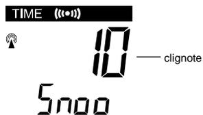
La temporisation de la fonction "Snooze" (= répétition de l'alarme) peut être désactivée (OFF) ou réglée jusqu'à un maximum de 30 minutes (10 minutes par défaut) :
