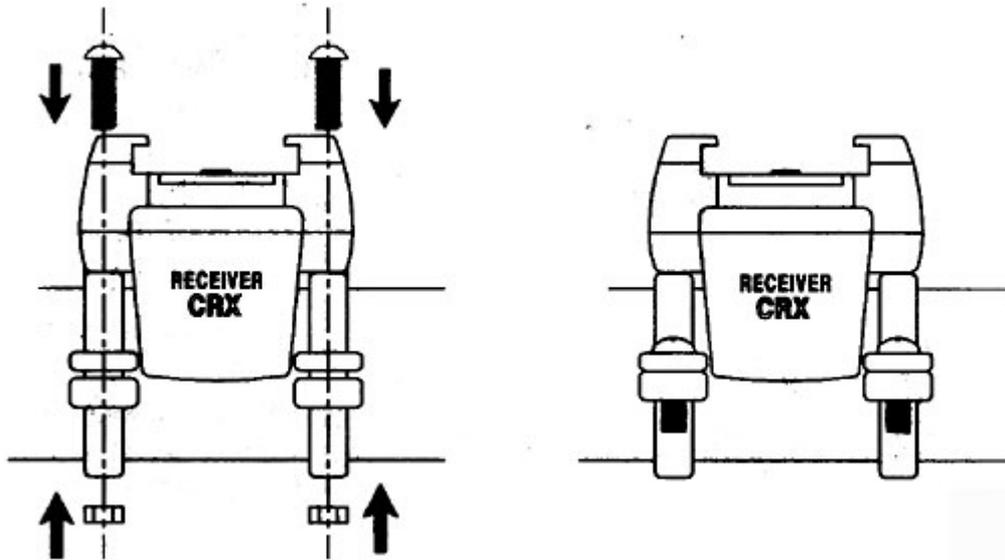
**ATTACHING THE CYCLE COMPUTER TO THE RECEIVER UNIT**
